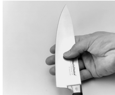
Abbildung 7. Sie fühlen den Grat, wenn Sie die Finger quer über die Klinge auf den Rücken zu führen.
