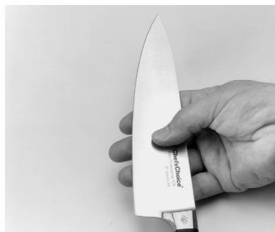
Figura 7. Se detecta la presencia de la rebaba deslizando los dedos a través y hacia fuera de la hoja.
