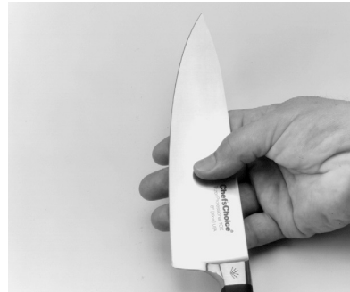
Afbeelding 7. U kunt de braam voelen als u met uw vingers voorzichtig langs de snede gaat.
