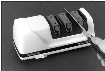
Figur 8. Införing av bladet i endast vänster skåra i steg 3. Dra växelvis i vänster skåra och höger skåra.
