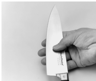
Малюнок 7. Задилок можна помітити, рухаючи пальцями впоперек і від кромки леза.
