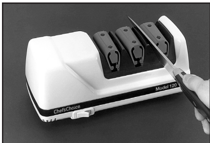
Afbeelding 8. Plaats het mes in de linksleuf van slijpgang van Slijpgang 3. Het mes afwisselend door de linker- en rechtersleuf trekken.
